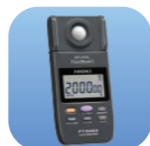
การตรวจวัดความเข้มแสงสว่าง Lux Meter
